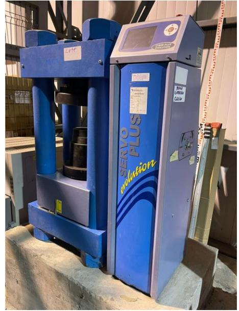
**DETALLE: 1 MÁQUINA DE PRENSA COMPRESIÓN Y FLEXIÓN LABORATORIO**
