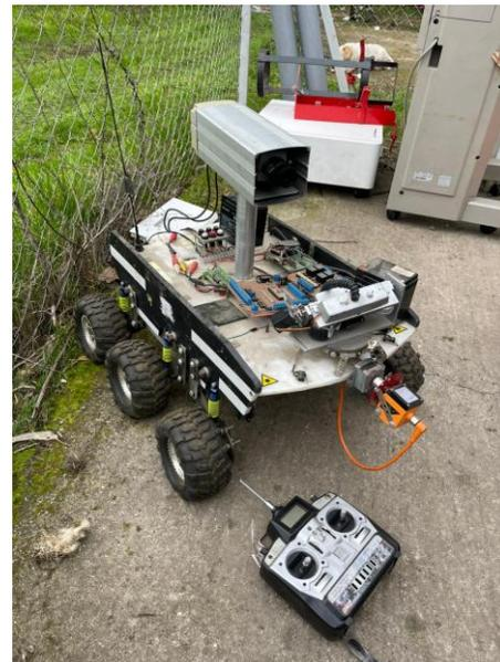
**DETALLE: 1 ROBOT DE INSPECCIÓN CON CÁMARAS Y COMANDO**
