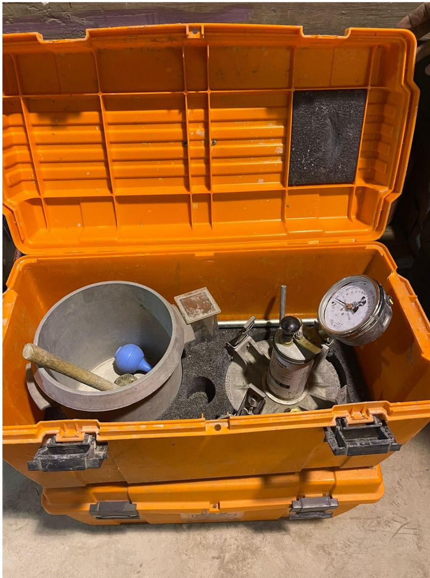
**DETALLE: 2 MEDIDORES DE CONTENIDO DE AIRE PARA HORMIGÓN FRESCO**
