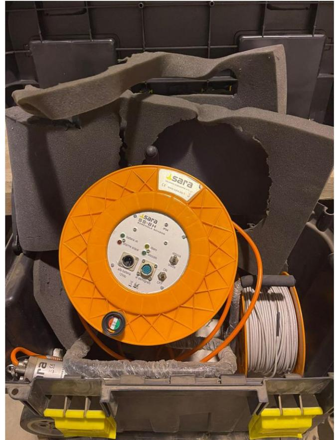
**DETALLE: 2 SONDA DE NIVEL DE AGUA MARCA SARA**
