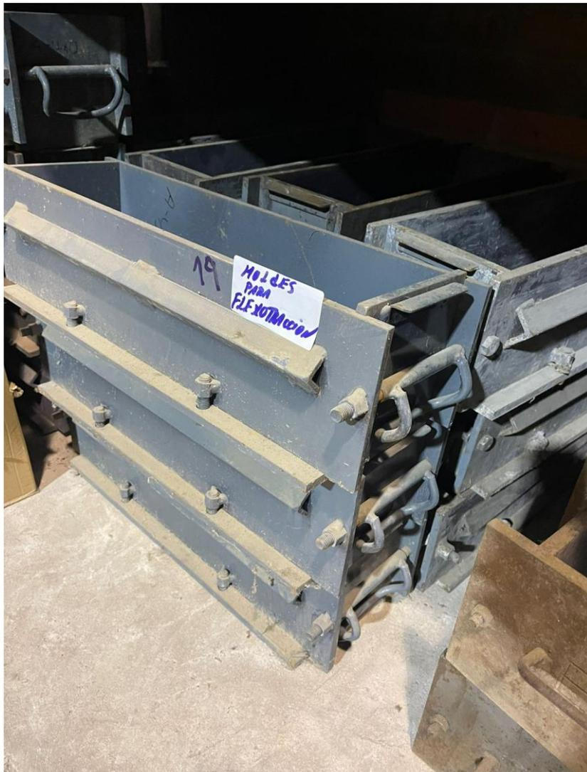
**DETALLE: 32 ART LABORATORIO // 6 PISON PROCTOR, 23 MOLDES PARA FLEXOTRACCION , 3 MOLDES PLÁSTICOS.**
