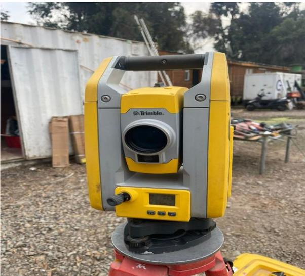
**DETALLE: 1 UN ESTACIÓN TOTAL TOPOGRÁFICA MARCA TRIMBLE OPERATIVA CON TRÍPODE.**
