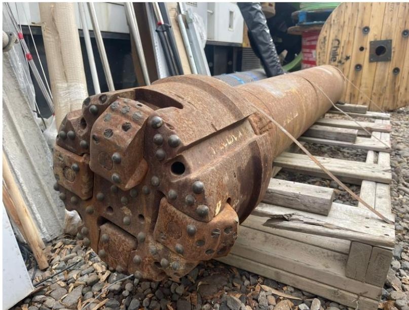
**DETALLE: 1 UN HERRAMIENTA BROCA DE PERFORACIÓN CASING ADVANCE 16" / PARA PERFORACIÓN DE POZOS PROFUNDOS.**
