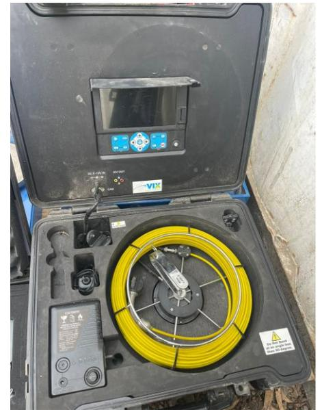
**DETALLE: 1 UN SISTEMA CÁMARA PARA INSPECCIÓN DE TABIQUES CON MONITOR DRY PIPEN.**
