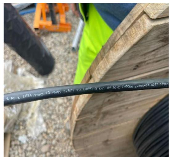
**DETALLE: 1 ROLLO DE 335 MTS CABLE MULTIFLEX RVK 1X 26,7 M2**
