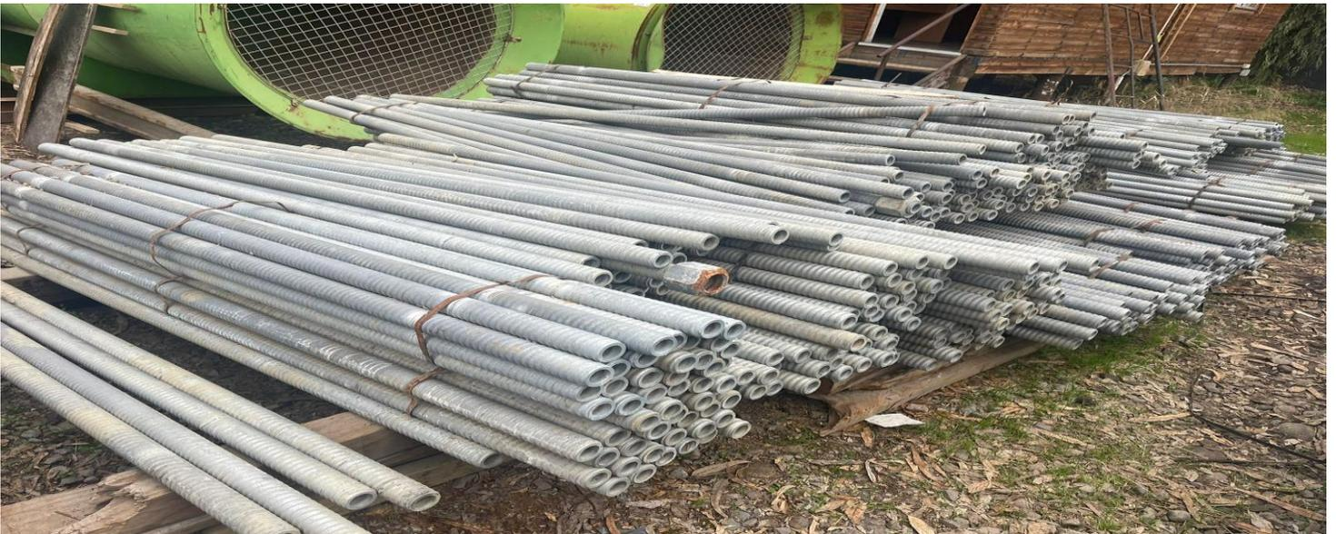
**DETALLE: 2500 UN PERNOS // GALVANIZADOS R- 51 // 2 MI CANTIDAD 1646 Y EN 3 MT 885 UN // PARA SOSTENIMIENTO DE TÚNELES Y TALUDES.**
