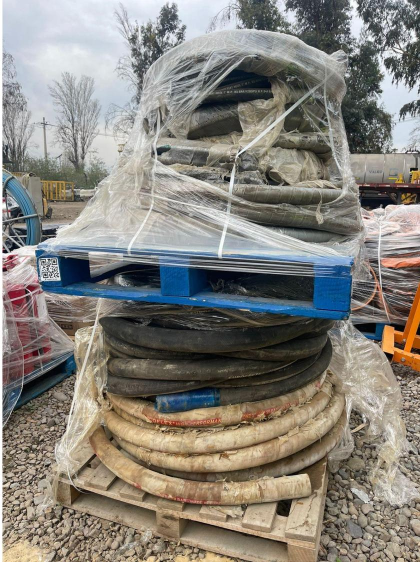
**DETALLE: 4 ROLLOS MANGUERA 2" PARA SHOTCRETE 15MTS CADA ROLLO.**
